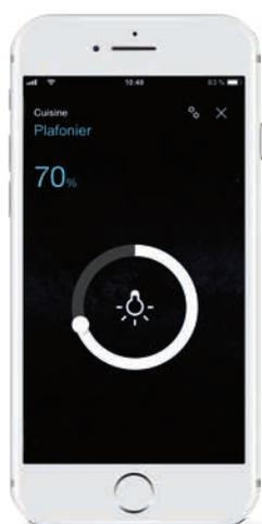
Commande d'une ampoule pour: MAR/ARR et variation (KNX, DALI ou Hue)
