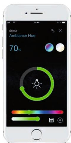
Commande d'une ampoule pour: MAR/ARR, variation, réglage de la couleur et de la température de couleur (KNX, DALI ou Hue)
